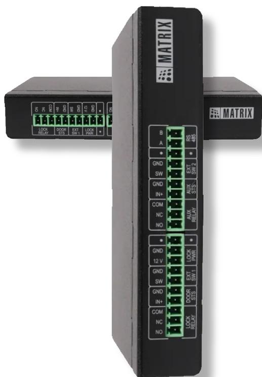
Le contrôleur ARC gère une porte. Il est relié au Nano Master via réseau IP (ou via RS485).
